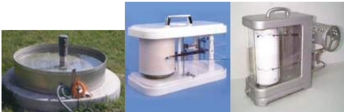
Figura 59 - Tanque Evaporimétrico, Termógrafo e Termohigrógrafo
