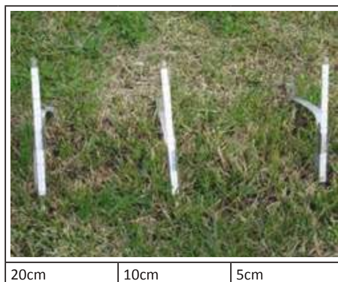
Figura 61 - Termómetros de solo (Os valores referem-se à profundidade a que é medida a temperatura)
